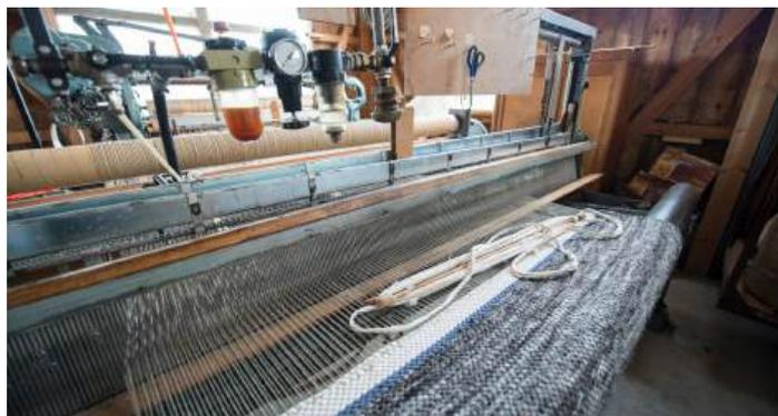
*Die halbautomatische Webmaschine.*
